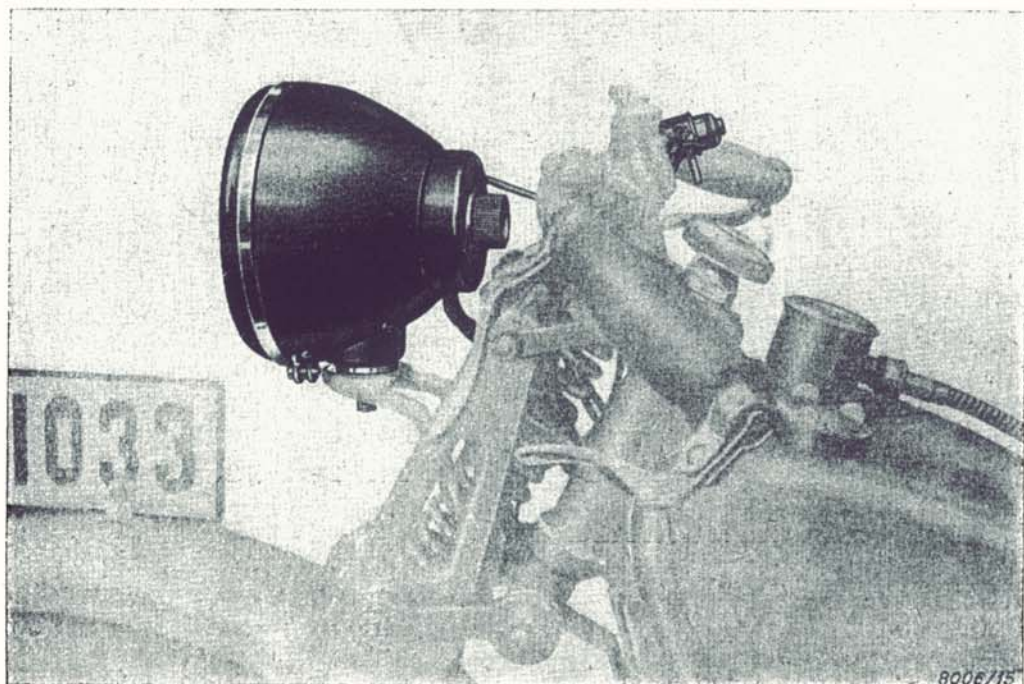
Bild 8. Scheinwerfer am Motorrad befestigt
